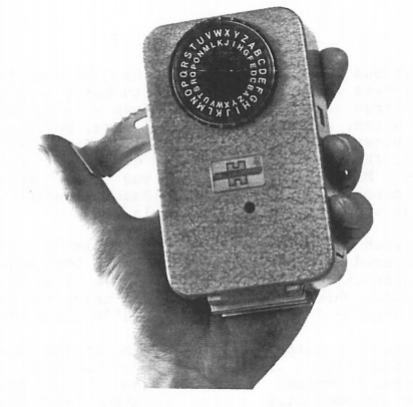
Slika 1.6: Džepna naprava za šifriranje
