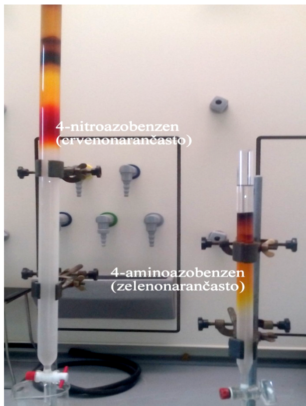
Slika 3. Odvajanje pripremljenih 4-nitrozobenzol (lijeva kolona), odnosno 4-aminoazobenzol (desna kolona) kromatografijom na stupcu silikagela.
