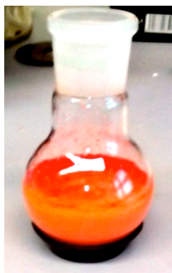
Slika 2. Sintetizirani 4-nitroazobenzen kondenzacijom anilina i p-nitronitrozobenzena.
