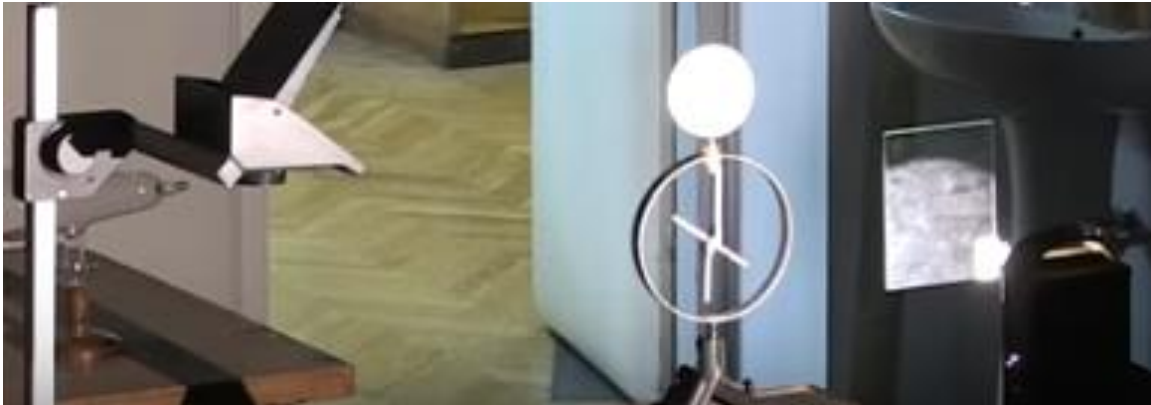
Slika 6.: Demonstracija otklona listića elektroskopa na zidu.
