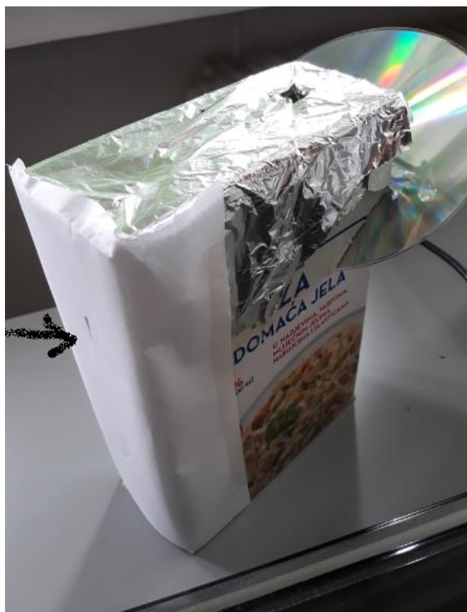
Slika 14.: Spektroskop od kutije riže, strelica pokazuje na mjesto gdje se nalazi pukotina.
