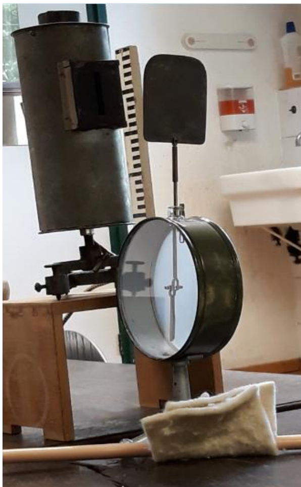
Slika 4.: Postav za demonstraciju fotoelektričnog efekta na fakultetu.
