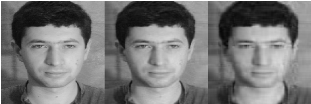
Slika 2.1: Aproksimacija slike nižim rangom. Originalna slika (lijevo) je veličine 512 \times 352 piksela. Sliku u sredini smo dobili postavljajući k na 35, a desno na 15 (vidi 2.2.1). Uočimo da se smanjenjem ranga značajno gubi na kvaliteti. Slika je uzeta iz Weizmann baze [1].
