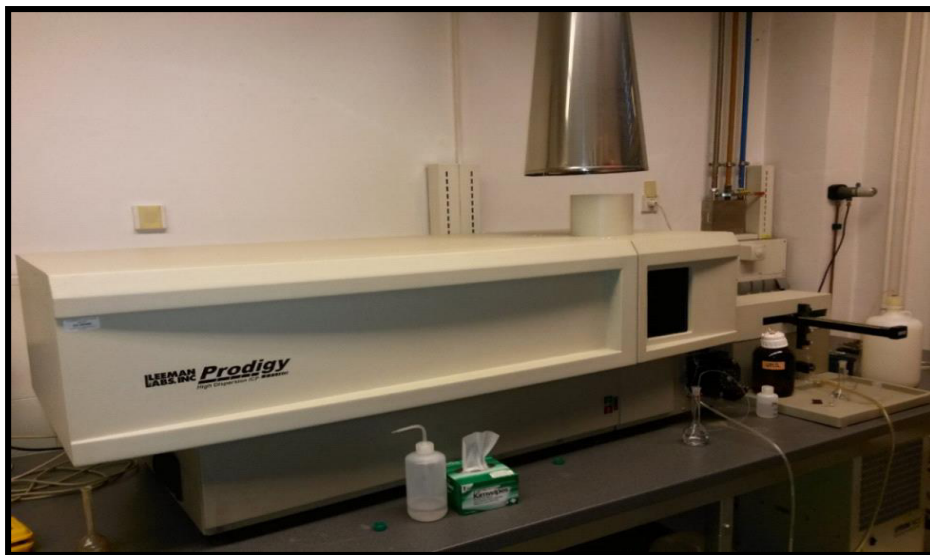
Slika 11. Optički emisijski spektrometar Prodigy High Dispersion ICP (Teledyne Leeman Labs., Hudson, NH, USA)
