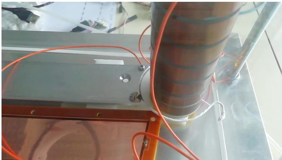
Slika 5.9: Napon je na GEM-u i “skirt”-u, a šipka je uzemljena, udaljenost šipka-žica \approx 6.5 mm, izboj na 5.4 kV.
