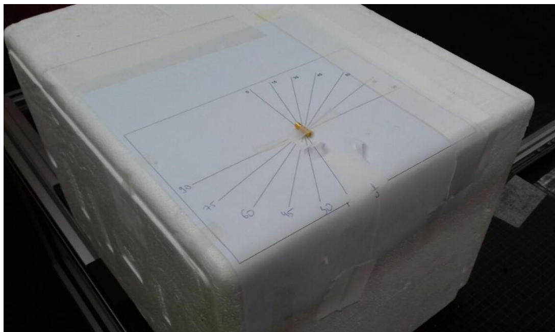
Slika 3.11 Eksperimentalni postav za mjerenje kutne ovisnosti
