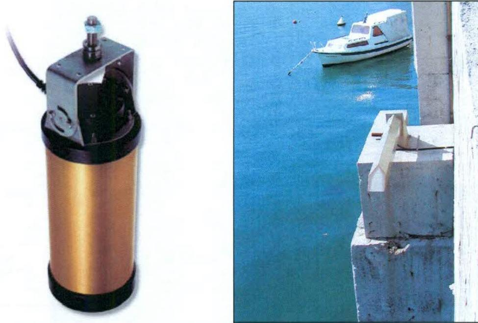
Slika 2.2: Radarski mareograf Kalesto (lijevo) i nosač unutar kojeg se nalazi uređaj postavljen u Bakru, slika preuzeta iz [9].
