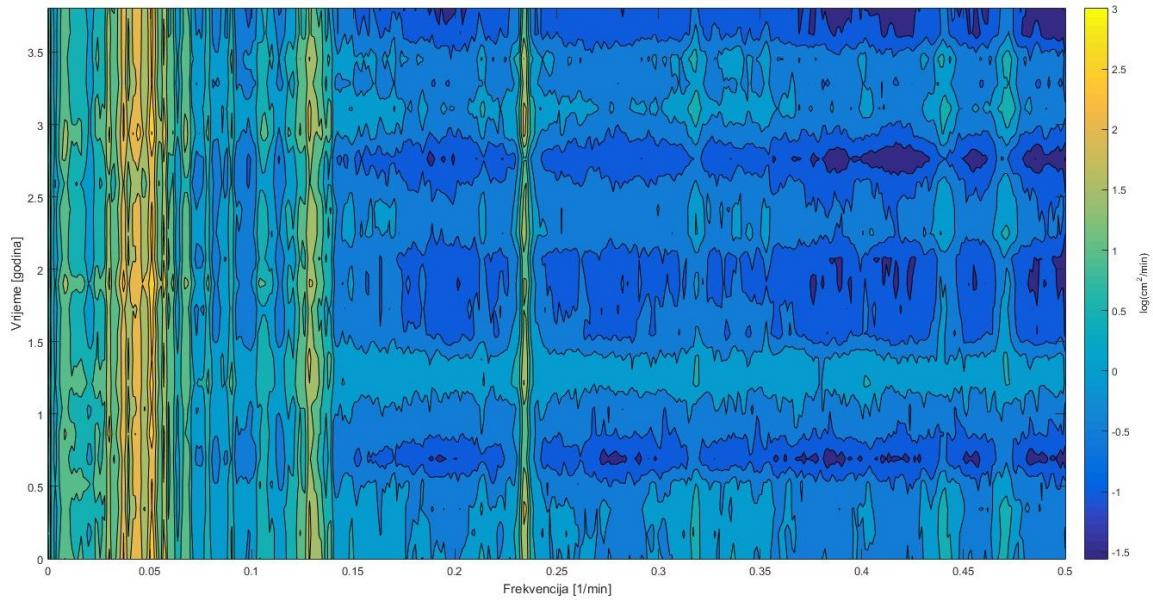
Slika 3.5: Spektar snage u vremenu za visokofrekventni niz.
