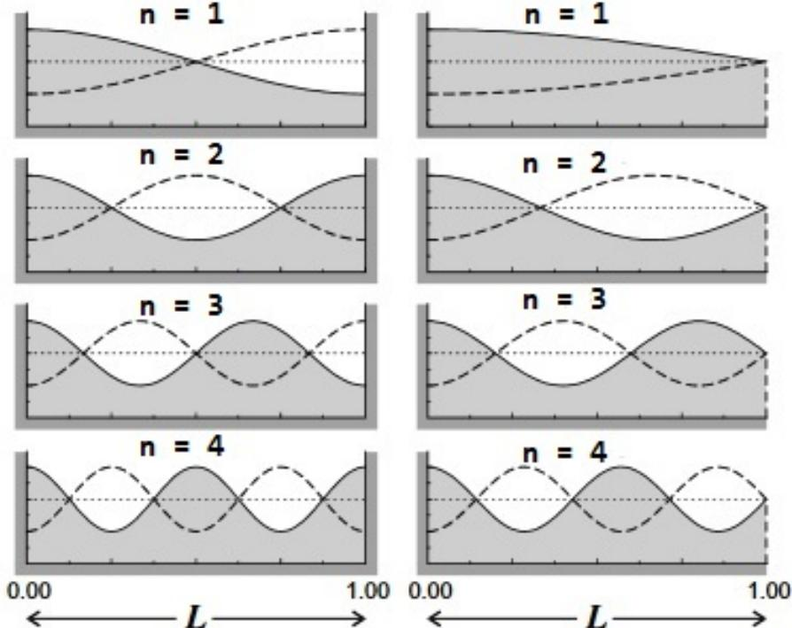
Slika 2.3: Prikaz prva četiri moda osciliranja za zatvoren bazen i za zaljev. Slika je preuzeta iz [10].
