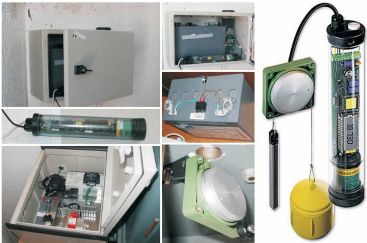
Slika 2.1: OTT Thalimedes, prikaz uređaja prije i nakon postavljanja, slika preuzeta iz [8].
