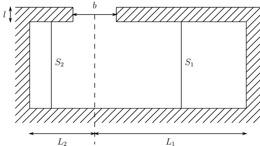
Slika 2.4: Shematski prikaz bazena s jednim otvorom postavljenim okomito na tok glavnog korita.
