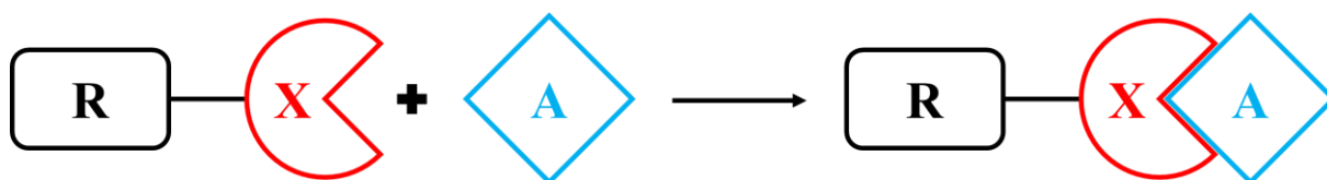
Slika 1. Nastanak halogenske veze. R = C , halogen, dušik; X = I, Br, Cl, F ; A = N, O, S, Se, I^-, Br^-, Cl^-, F^-
