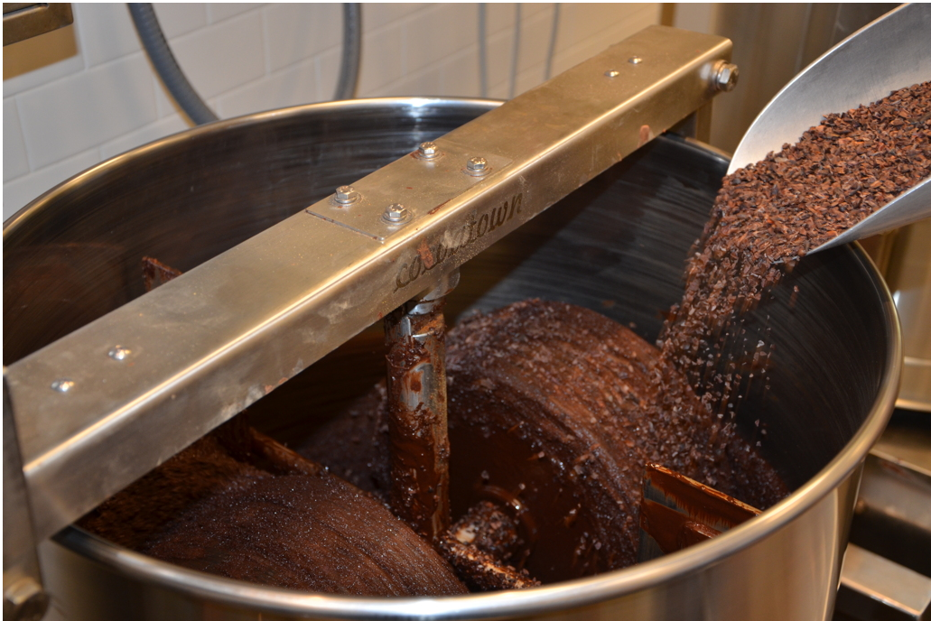
Slika 15. Prerada kakao zrna u procesu mljevenja
