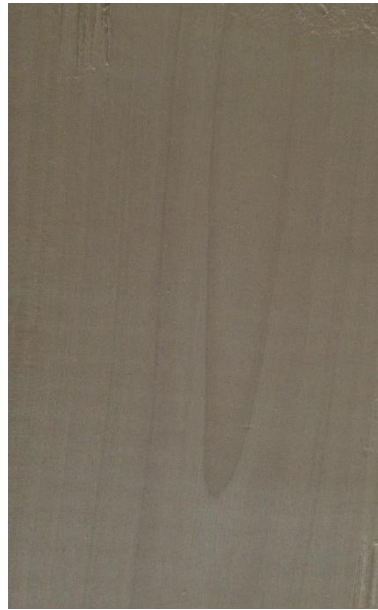
Slika 84. Tangentni presjek drva crnog graba
