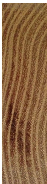
Slika 90. Poprečni presjek drva običnog bagrema
