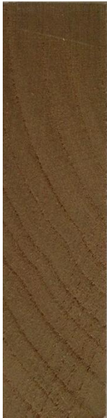
Slika 160. Poprečni presjek drva divlje trešnje
