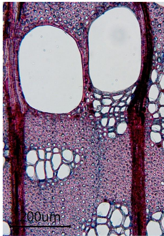
Slika 157. Poprečni presjek drva bijelog jasena, povećanje objektiva 10X
