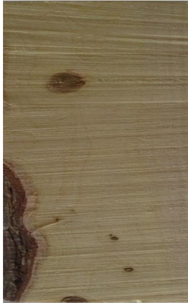
Slika 2. Tangentni presjek drva obične borovice
