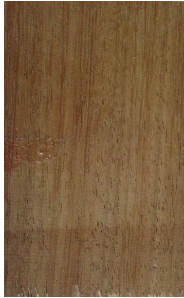
Slika 133. Tangentni presjek drva iroka
