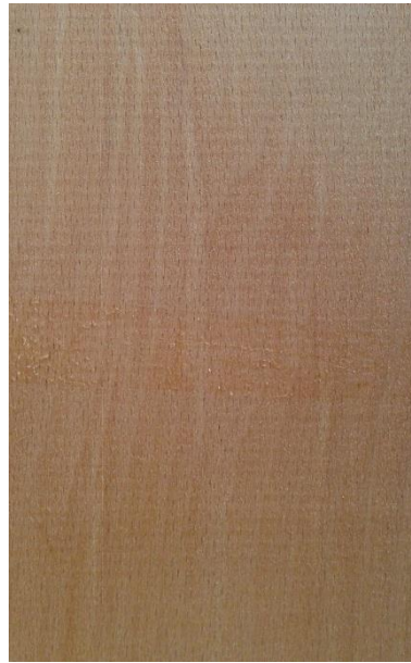
Slika 105. Tangentni presjek drva obične bukve
