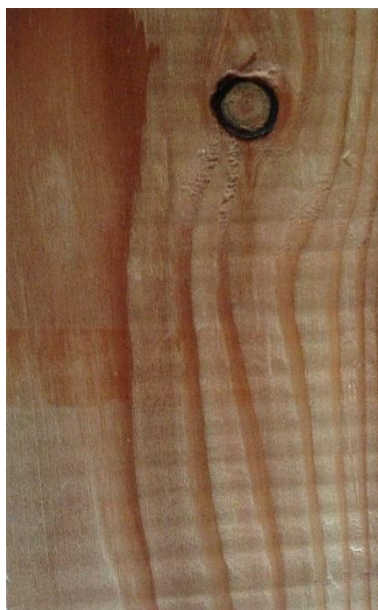
Slika 16. Tangentni presjek drva europskog ariša
