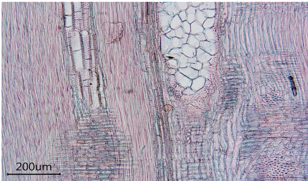
Slika 96. Radijalni presjek drva običnog bagrema
