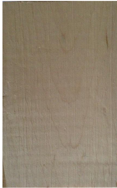
Slika 77. Tangentni presjek drva obične lijeske
