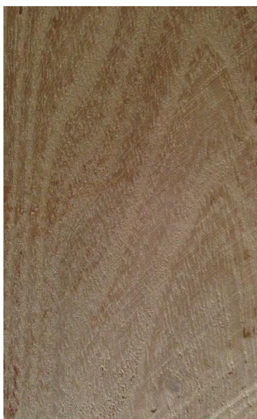
Slika 91. Tangentni presjek drva običnog bagrema
