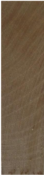
Slika 167. Poprečni presjek drva pitome kruške
