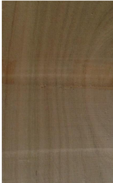
Slika 161. Tangentni presjek drva divlje trešnje
