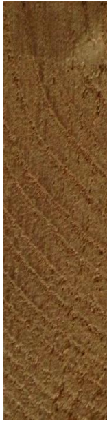
Slika 97. Poprečni presjek drva europskog pitomog kestena
