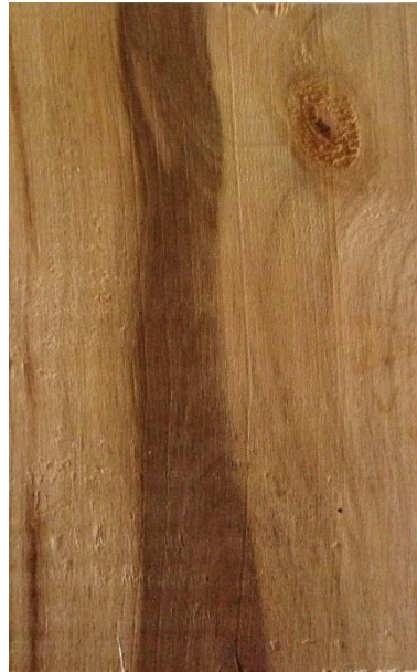
Slika 119. Tangentni presjek drva pravog lovora
