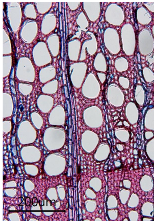
Slika 164. Poprečni presjek drva divlje trešnje, povećanje objektiva 10X
