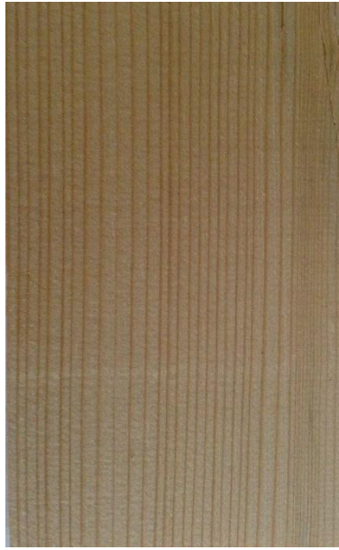
Slika 23. Tangentni presjek drva obične smreke
