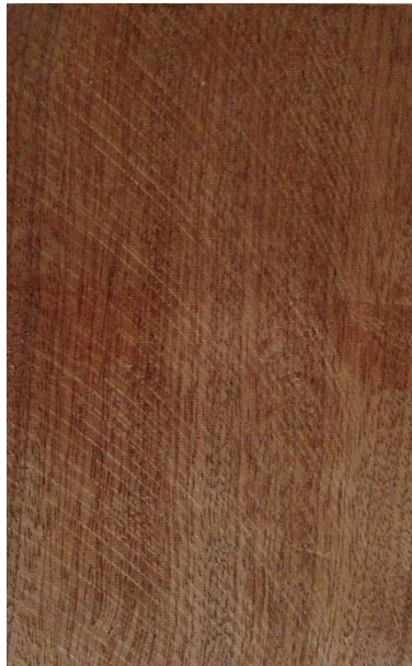
Slika 126. Tangentni presjek drva američkog mahagonija
