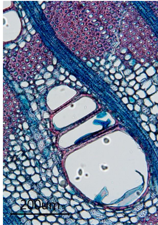
Slika 136. Poprečni presjek drva iroka, povećanje objektiva 10X
