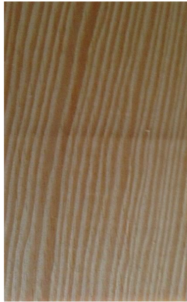
Slika 44. Tangentni presjek drva bijelog bora
