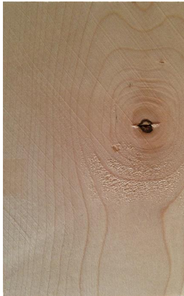
Slika 51. Tangentni presjek drva gorskog javora
