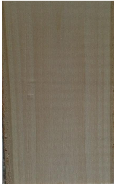
Slika 189. Tangentni presjek drva lipa
