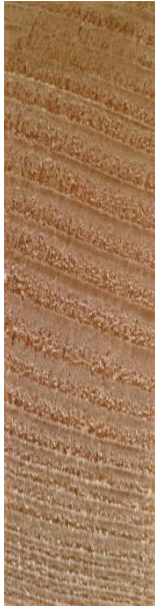
Slika 8. Poprečni presjek drva obične jele
