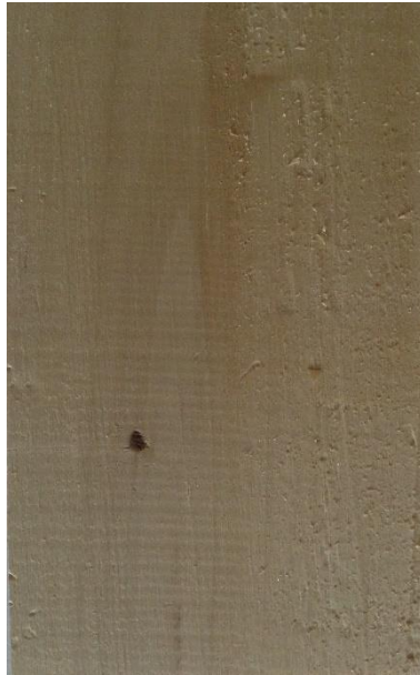
Slika 182. Tangentni presjek drva topole
