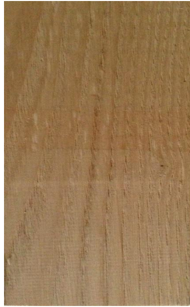
Slika 98. Tangentni presjek drva europskog pitomog kestena
