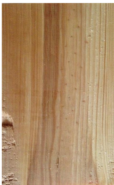
Slika 30. Tangentni presjek drva crnog bora
