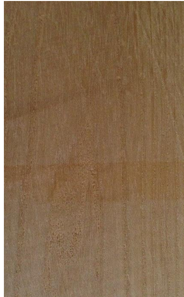
Slika 154. Tangentni presjek drva bijelog jasena
