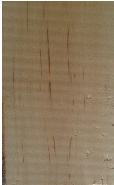
Slika 175. Tangentni presjek drva obične muginje
