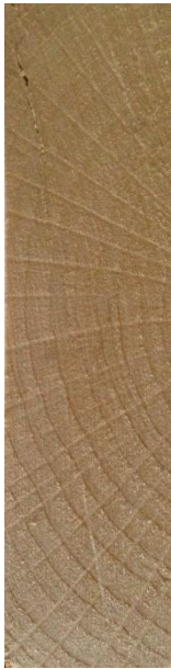
Slika 76. Poprečni presjek drva obične lijeske
