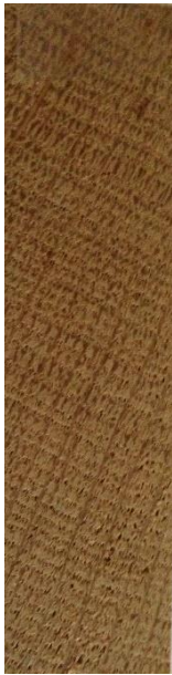
Slika 111. Poprečni presjek drva hrasta
