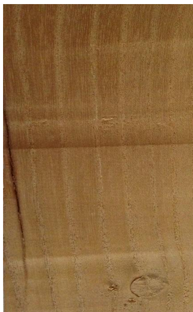
Slika 146. Tangentni presjek drva crnog dudu
