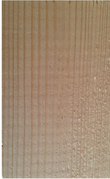
Slika 9. Tangentni presjek drva obične jele
