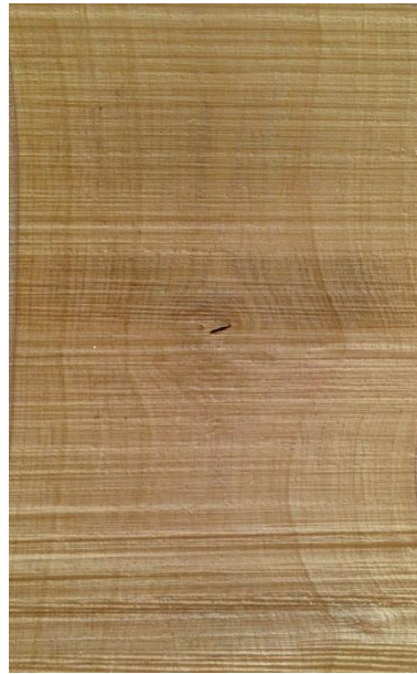
Slika 139. Tangentni presjek drva obične smokve
