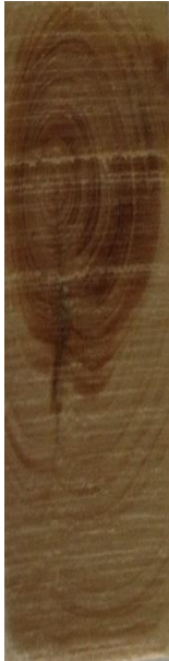
Slika 1. Poprečni presjek drva obične borovice
