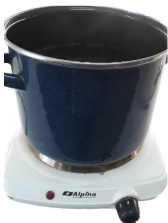
Slika 1. Prikaz omekšavanja drva kuhanjem u destiliranoj vodi
