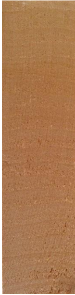
Slika 56. Poprečni presjek drva joha
