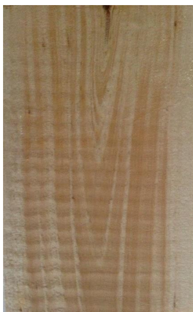
Slika 37. Tangentni presjek drva američkog borovca
