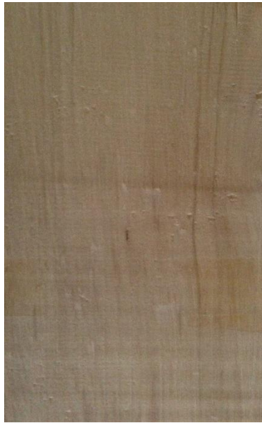
Slika 71. Tangentni presjek drva običnog graba
