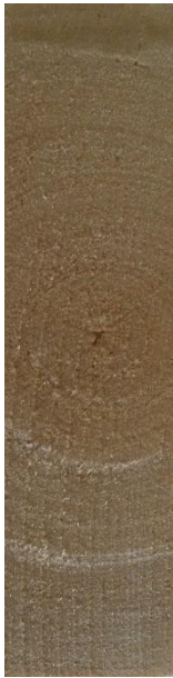
Slika 63. Poprečni presjek drva obične breze
