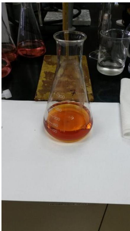
Slika 7 Opažena promjena boje po završetku titracije
