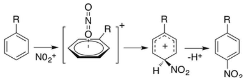
Slika 11. Skraćeni prikaz upotpunjenoj  $S_{\text{E}}\text{Ar}$  mehanizma nitriranja
