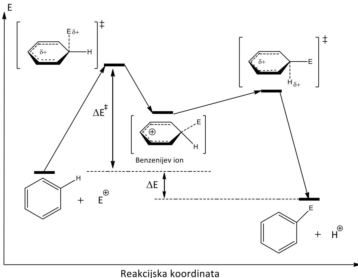
Slika 11. Energetski dijagram S<sub>E</sub>Ar mehanizma.
