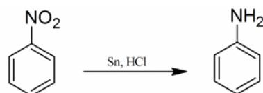
Slika 4. Priprava anilina jednostavnom redukcijom nitrobenzena
