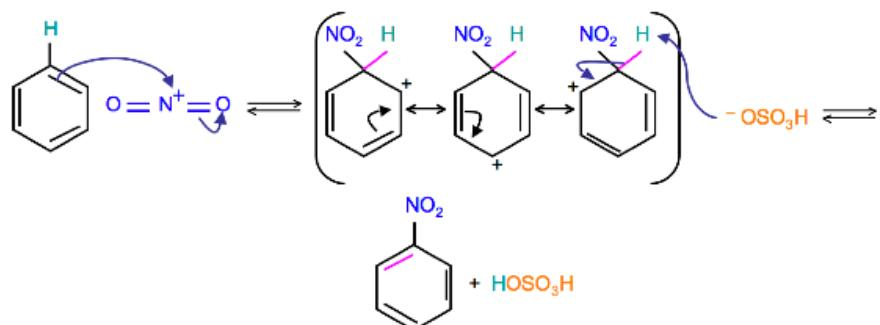
Slika 9. Drugi korak u mehanizmu nitriranja benzena. Benzen napada  $\text{NO}_2^+$  ion jer je on dobar elektrofil pri čemu nastaje nitrobenzen.
