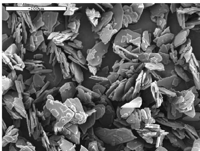
Slika 74. SEM slika kristala MMN HSUL forme 1 pripremljenih u industrijskom mjerilu (1000 L).
