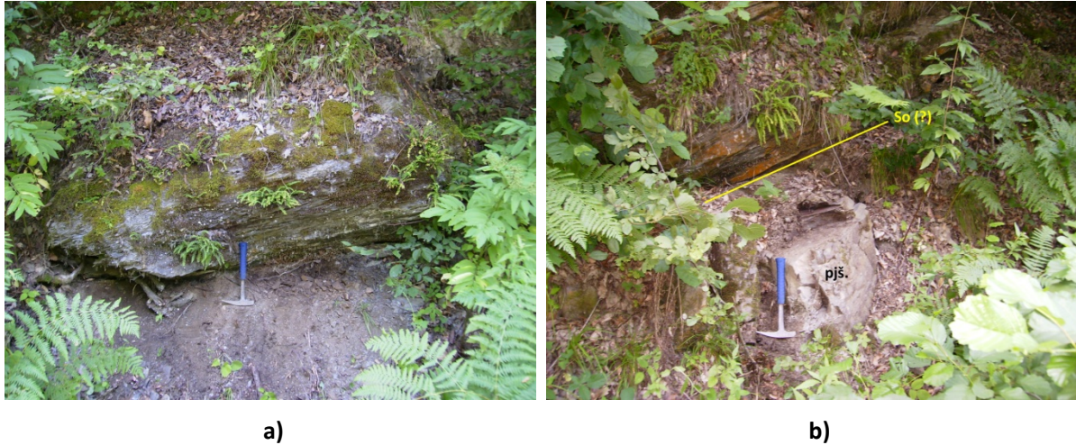
Slika 4.6: a) izdanak pjeskovitog šejla; b) izdanak pjeskovitog šejla s pješčenjakom (pjš.) u podini. S_o – slojna ploha (pretpostavljena).
