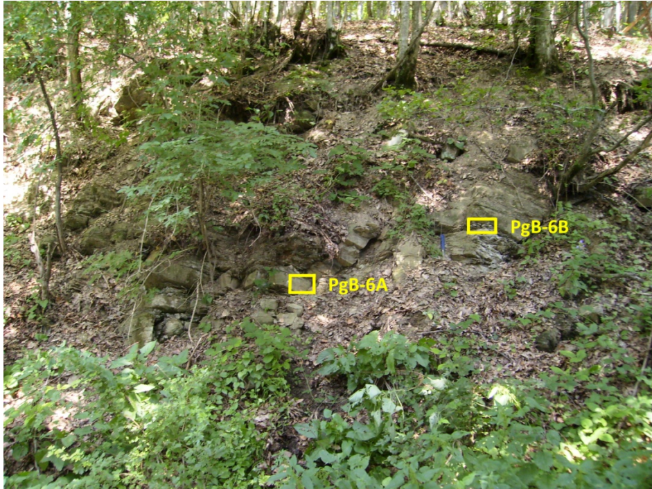
Slika 4.7: Izdanak s vidljivom izmjenom srednjezrnatih i sitnozrnatih klastita (pješčenjaka i šejlova), te s označenim mjestima uzorkovanja pješčenjaka (uzorak PgB–6A) i pjeskovitog šejla (PgB–6B).
