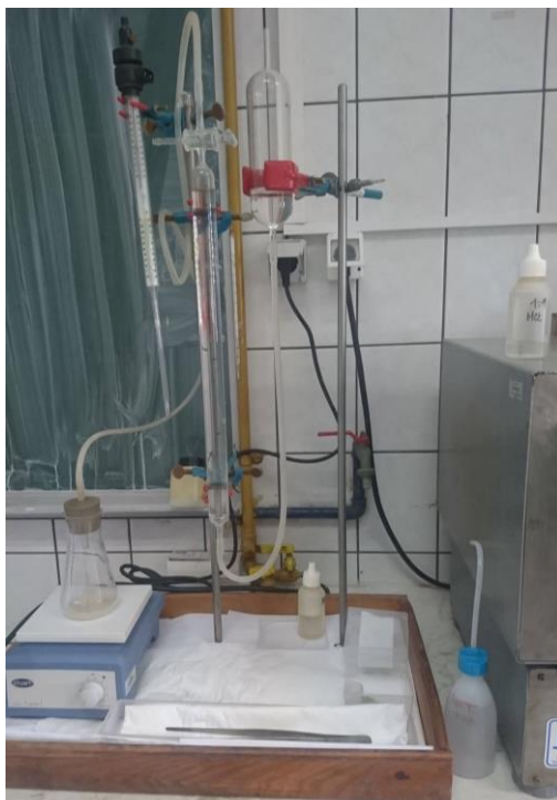
Slika 13. Scheiblerov kalcimetar u laboratoriju MPZ-a.
