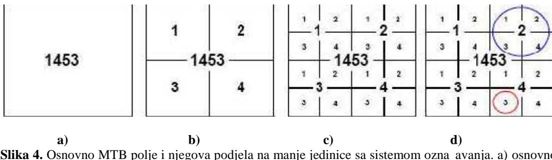
**Slika 4.** Osnovno MTB polje i njegova podjela na manje jedinice sa sistemom označavanja. a) osnovno polje, b) četvrtina (MTB 1/4), c) šesnaestina (MTB 1/16), d) primjer (preuzeto iz NIKOLI 2006).
