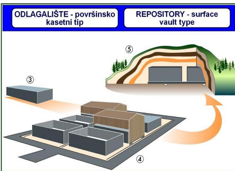
Slika 3. Polaganje betonskih spremnika ispod površine
