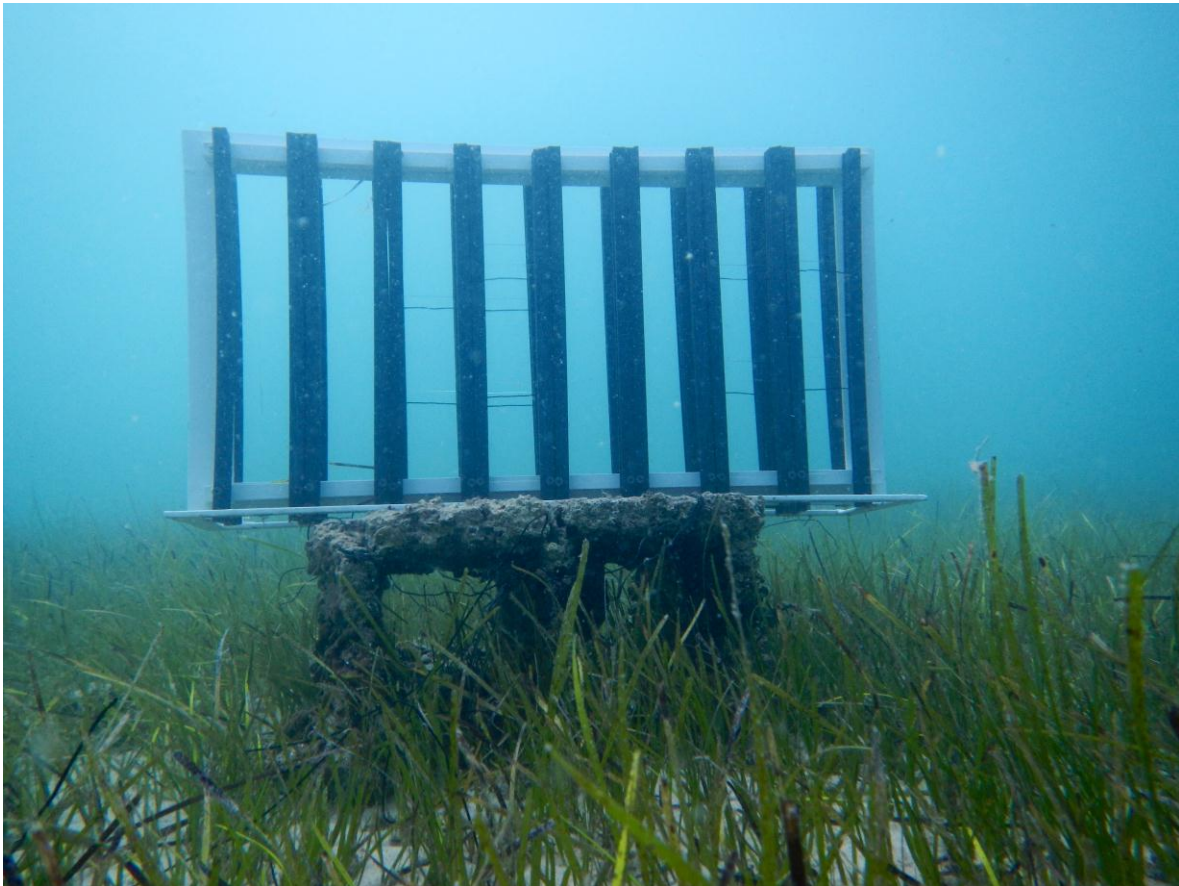
Slika 14. Konstrukcija sa pleksiglas pločicama postavljena u naselje morske cvjetnice Cymodocea nodosa
