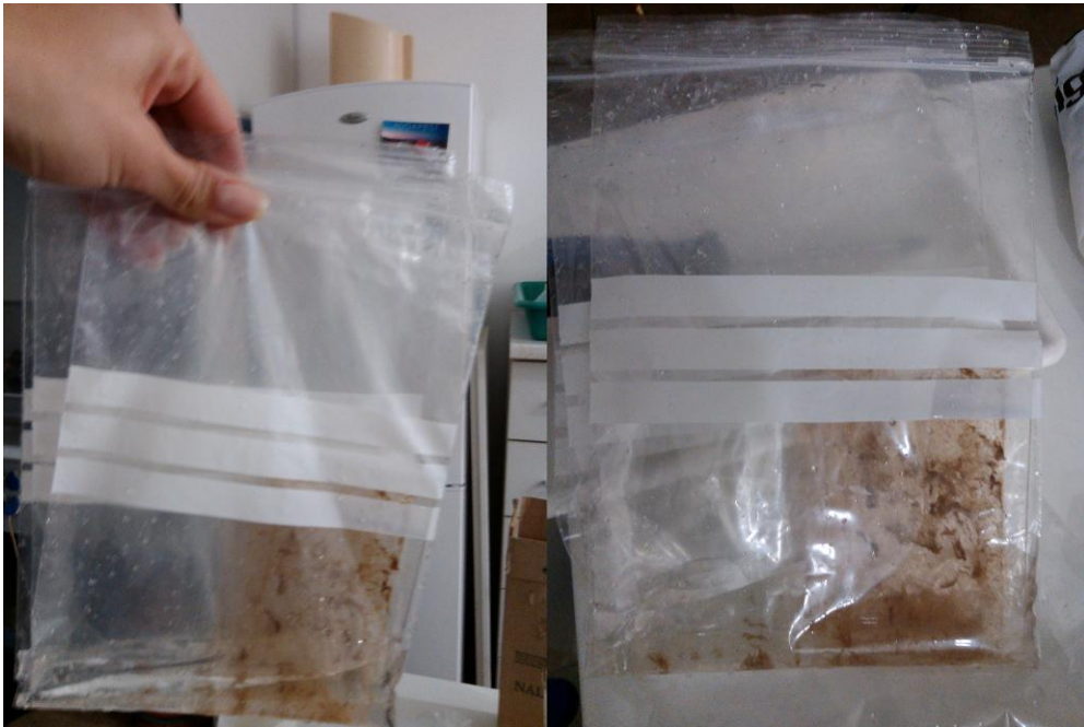
Slika 16. Sterilne vrećice sa pleksiglas pločicama na kojima je pričvršćen biofilm
