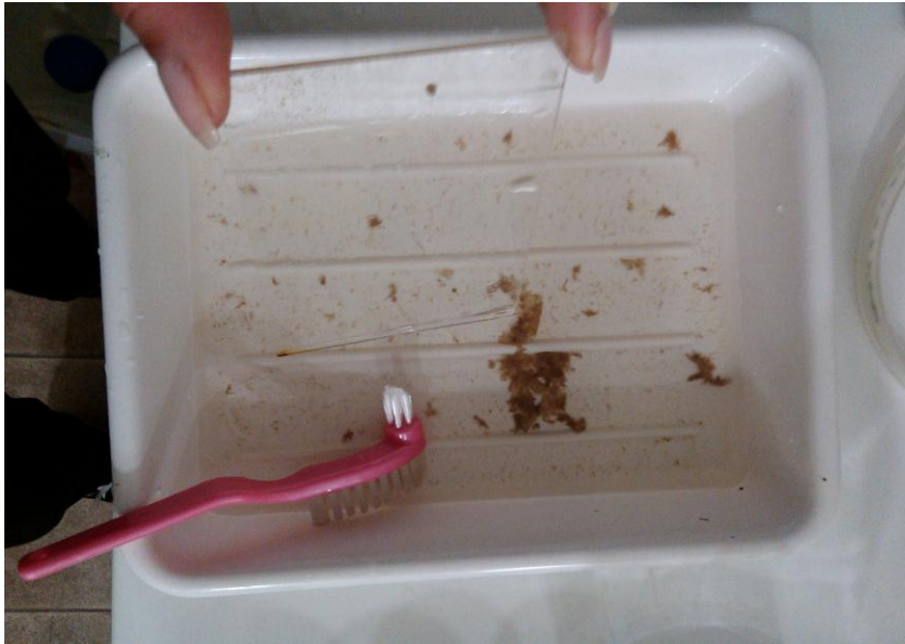
Slika 19. Struganje biofilma s pleksiglas pločice koristeći četkicu
