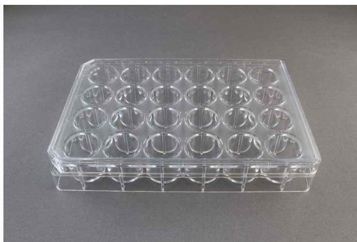
Slika 14. Ploča za kristalizaciju s 4x6 spremnika
