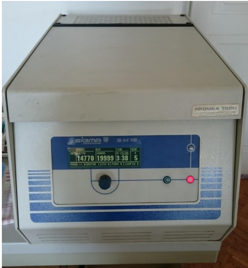
Slika 13. Visokookretajna centrifuga Sigma 3K18.
