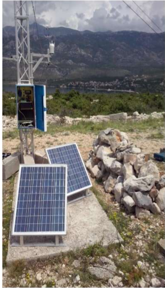
Slika 6. Lijevo: prikaz 10 m visokog tornja. Ultrazvučni anemometri nalaze se na visinama 2, 5 i 10 m. Desno: prikaz solarnih panela. U daljini je planina Velebit.
