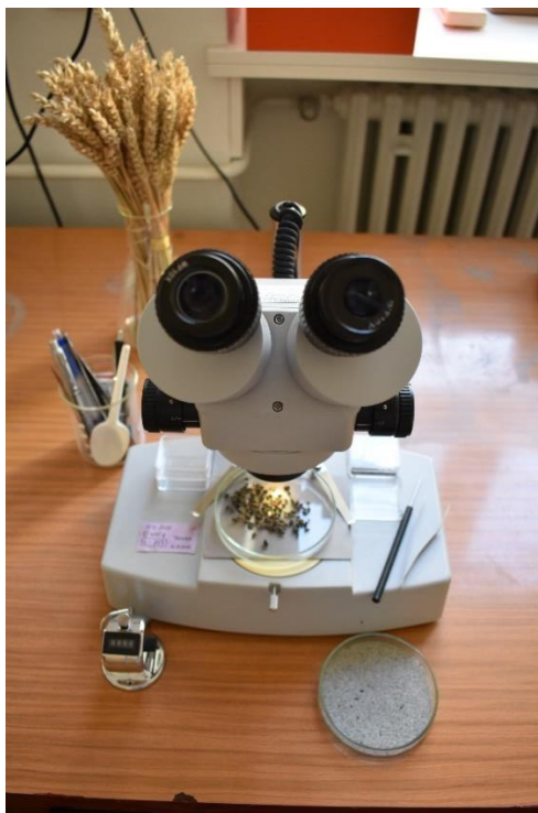
Slika 13. Binokularna lupa s povećanjem 7-45 x koja je korištena za determinaciju biljnih makrofosila pronađenih na lokalitetu Kalnik-Igrišće
