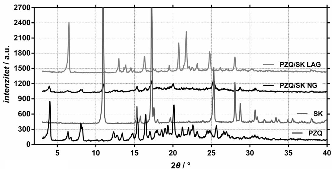
Slika 28. XRPD uzorak PZQ-a, salicilne kiseline (SK) i ekvimolarnog mljevenog produkta PZQ-a sa salicilnom kiselinom, oboje pripremljenih suhim mljevenjem (NG) i mljevenjem s dodatkom otapala (LAG).
