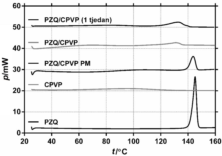
Slika 24. DSC termogrami PZQ, kopovidona (CPVP), hidrofilnog polimera odgovarajuće fizičke smjese (PM) i mljevenog produkta u masenom omjeru 1:1 odmah nakon pripreme te nakon tjedan dana čuvanja na sobnoj temperaturi.
