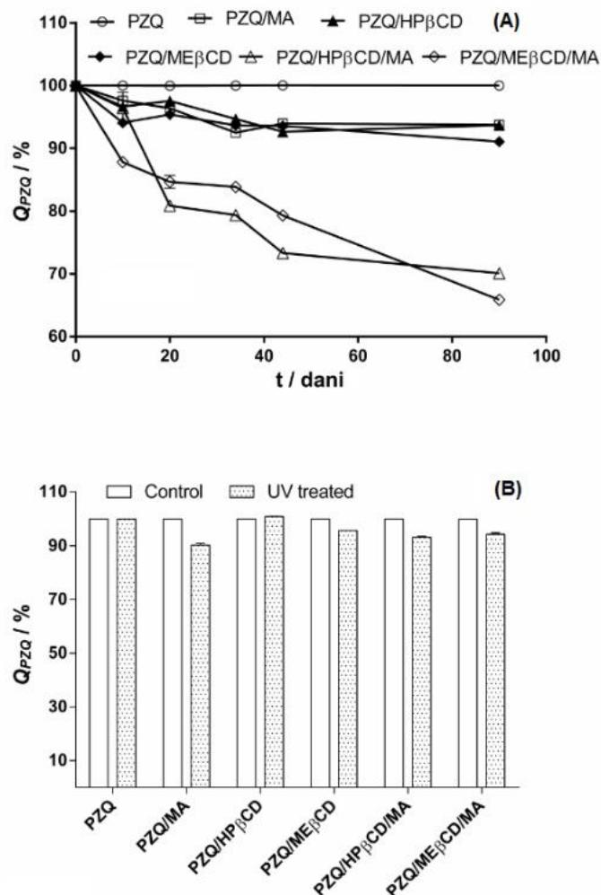
Slika 44. Promjene u koncentraciji PZQ-a u odabranim uzorcima tijekom ispitivanja kemijske stabilnosti lijeka metodom ubrzanog starenja na  $40 \pm 2$  °C /  $75 \pm 5\%$  RH (A) te tijekom ispitivanja fotostabilnosti (B).
