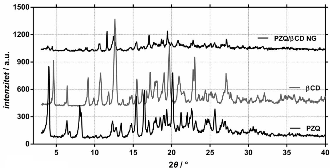
Slika 35. XRPD difraktogram PZQ-a,  $\beta$ -ciklodekstrina ( $\beta$ CD) i njihovog produkta pripremljenog suhim mljevenjem u ekvimolarnom omjeru (NG).
