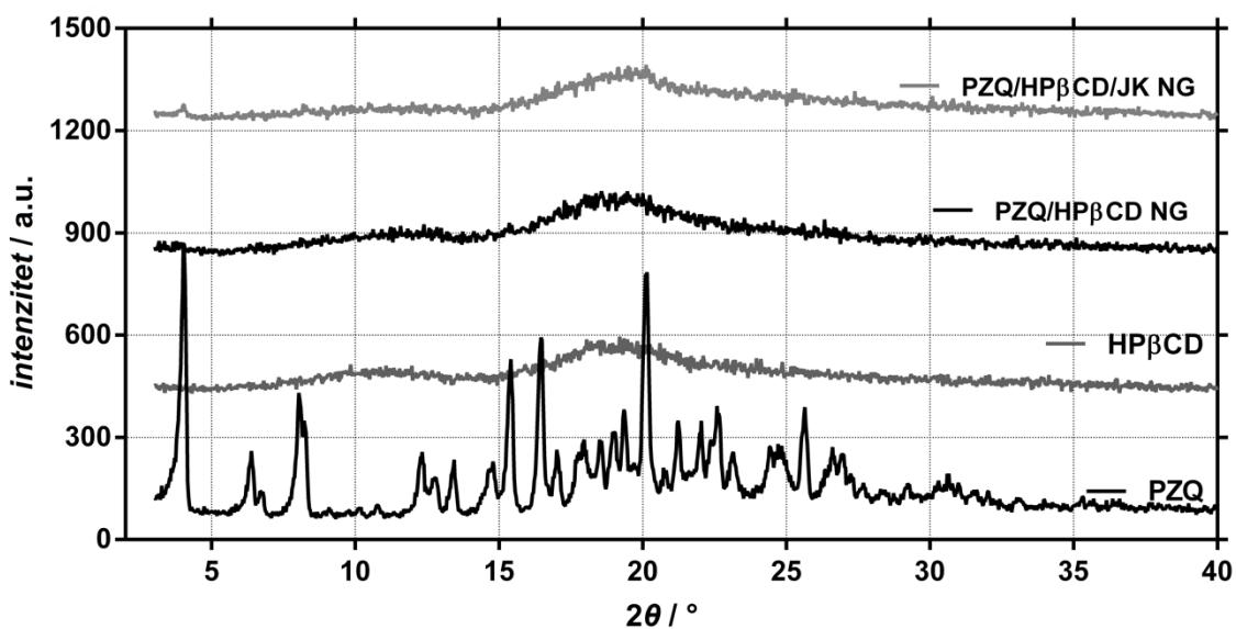
Slika 37. XRPD uzorak PZQ-a, hidroksi- $\beta$ -ciklodekstrina (HP $\beta$ CD) i njihov ekvimolarni mljeveni produkt pripremljen suhim mljevenjem (NG).
