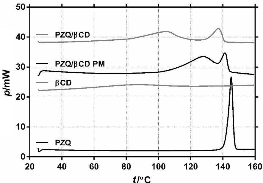
Slika 36. DSC termogram PZQ,  $\beta$ -ciklodekstrina ( $\beta$ CD), odgovarajuće fizičke smjese (PM) i mljevenog produkta u ekvimolarnom omjeru pripremljenog suhim mljevenjem (NG).
