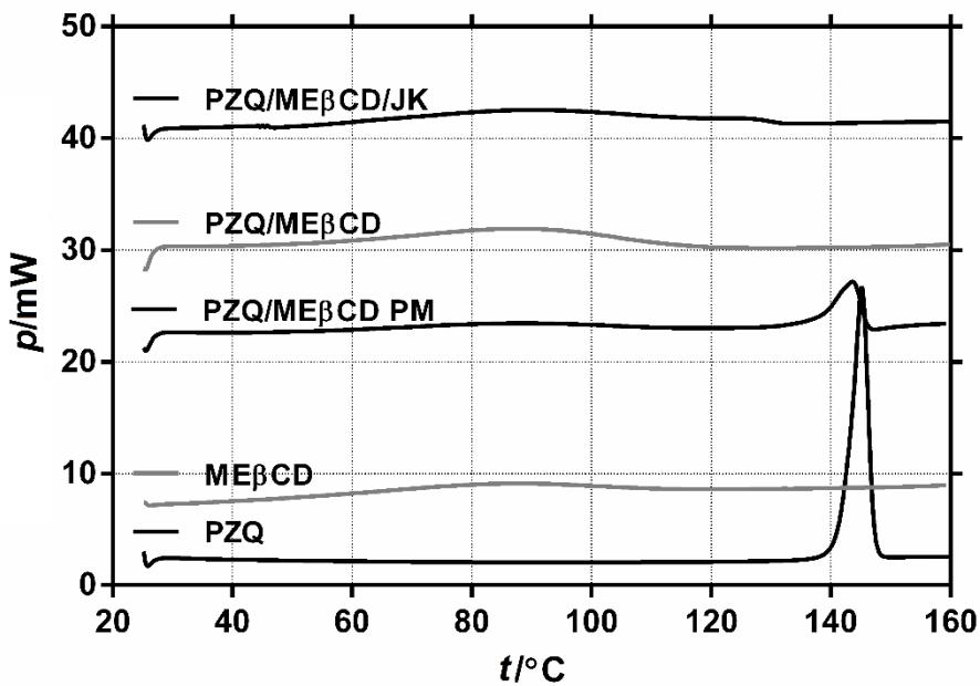
Slika 41. DSC termogram PZQ, metil- $\beta$ -ciklodekstrina (ME $\beta$ CD), odgovarajuće fizičke smjese (PM) i mljevenog produkta u ekvimolarnom omjeru, kao i ternarnog mljevenog produkta u molarnom omjeru 1:1:1 s ME $\beta$ CD /JK pripremljenog suhim mljevenjem (NG).
