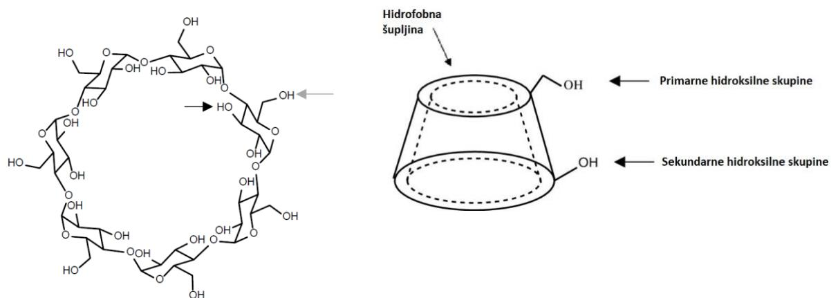
Slika 6. Orijentacija primarnih i sekundarnih hidroksilnih skupina unutar molekule ciklodekstrina.<sup>67</sup>
