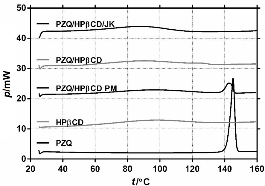
Slika 40. DSC termogram PZQ, hidroksi- $\beta$ -ciklodekstrina (HP $\beta$ CD), odgovarajuće fizičke smjese (PM) i mljevenog produkta u ekvimolarnom omjeru, kao i ternarnog mljevenog produkta u molarnom omjeru 1:1:1 sa HP $\beta$ CD/JK pripremljenog suhim mljevenjem (NG).
