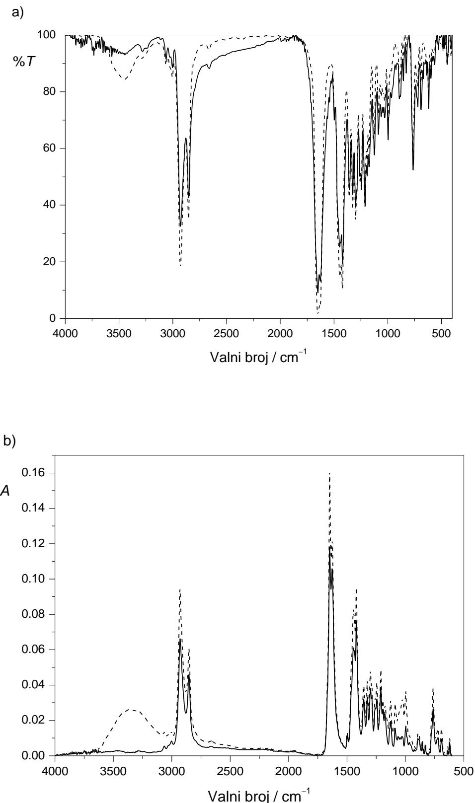
Slika 14. IR spektri PZQ prije (----) i nakon (—) suhog mljevenja. Transmisijski spektri (a) i spektri snimljeni tehnikom prigušene totalne refleksije (ATR) (b).
