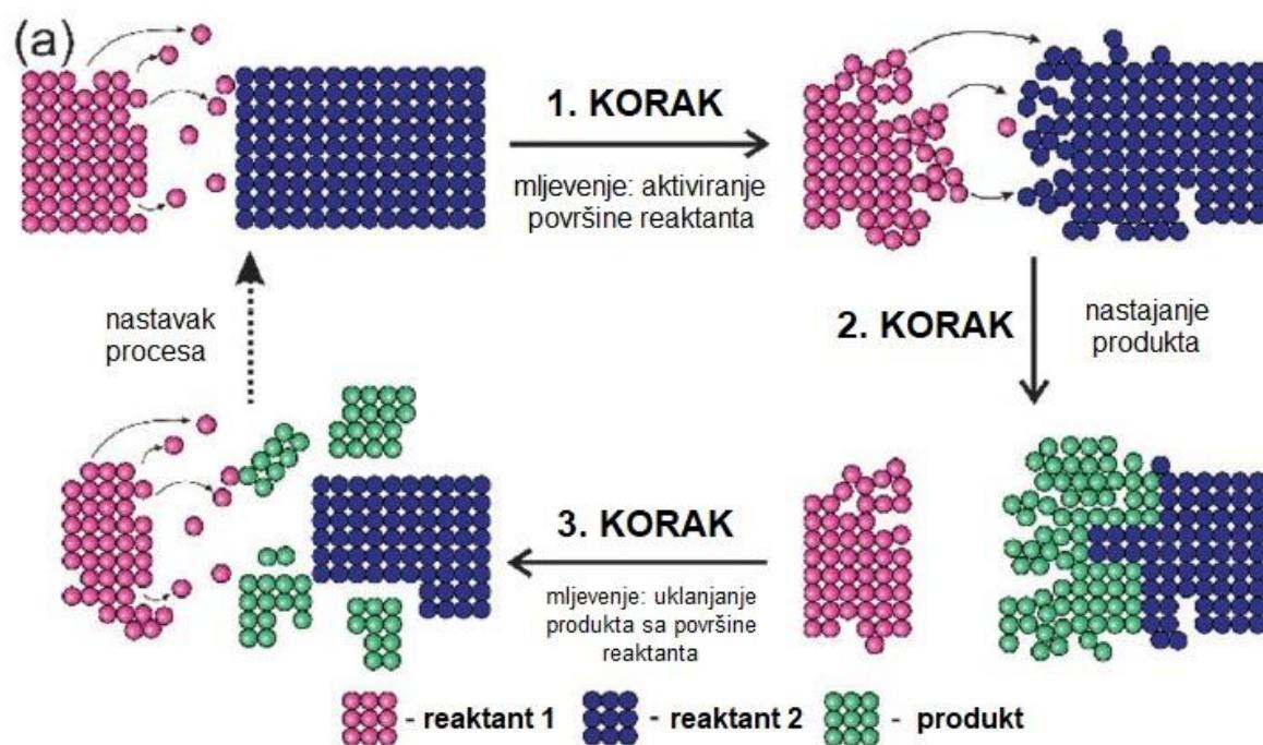
Slika 9. Shematski prikaz trostupanjskog modela mehanokemijskih transformacija postupkom mljevenja.<sup>10</sup>
