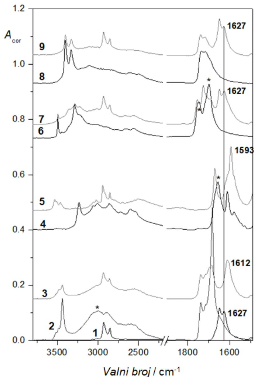
Slika 33. Segment FTIR-ATR spektara netretiranog lijeka, organskih kiselina i odgovarajućih binarnih produkata pripremljenih mljevenjem uz dodatak otapala u rasponu valnih brojeva od  $4000$  do  $1500\text{ cm}^{-1}$ : PZQ (1), JK (2), PZQ/JK (3), SK (4), PZQ/SK (5 ), LK (6), PZQ/LK (7), VK (8), PZQ/VK (9).
