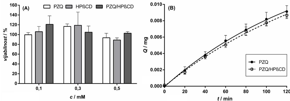
Slika 45. Utjecaj PZQ, HP $\beta$ CD i mljevenog produkta PZQ/HP $\beta$ CD na vijabilnost Caco-2 stanica određen MTT testom (A). Vrijeme inkubacije stanica iznosilo je 2 sata, a koncentracija ispitivanih uzoraka varirala je u rasponu od  $0,1$  do  $0,5 \times 10^{-3}$  mol L $^{-1}$ . *In vitro* profili permeabilnosti PZQ-a iz ispitivanih uzoraka nanesenih na Caco-2 stanični monosloj u koncentraciji od  $0,1 \times 10^{-3}$  mol L $^{-1}$  (B).
