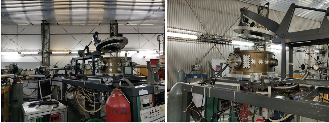
Slika 3.3: Prikaz linije za nuklearnu fiziku s komorom za mjerenje nuklearnih reakcija.
