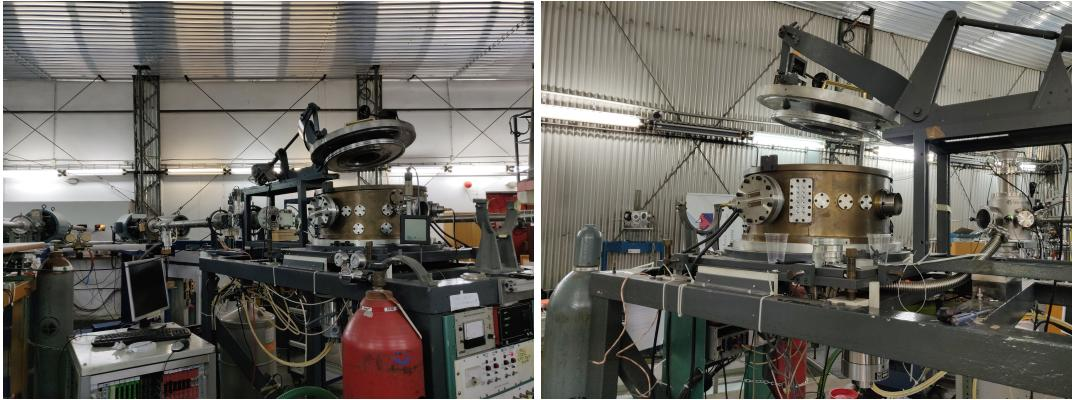
Slika 3.3: Prikaz linije za nuklearnu fiziku s komorom za mjerjenje nuklearnih reakcija.
