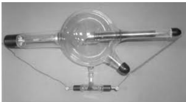
Slika 2. Fotografija rendgenske cijevi iz 1909.
