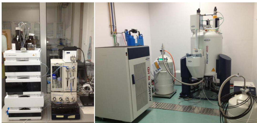
Slika 2.16. Spregnuti sustav LC-SPE/krio NMR.
