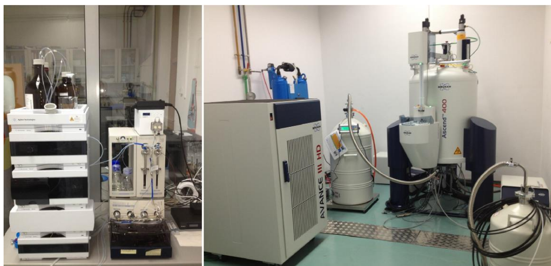
Slika 2.16. Spregnuti sustav LC-SPE/krio NMR.
