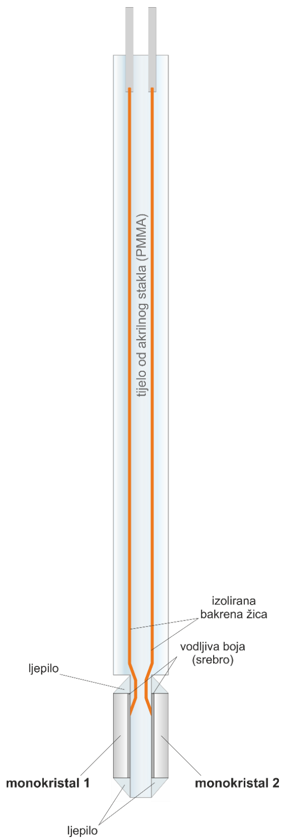
Slika 4.2. Shematski prikaz sustava dvije monokristalne elektrode.
