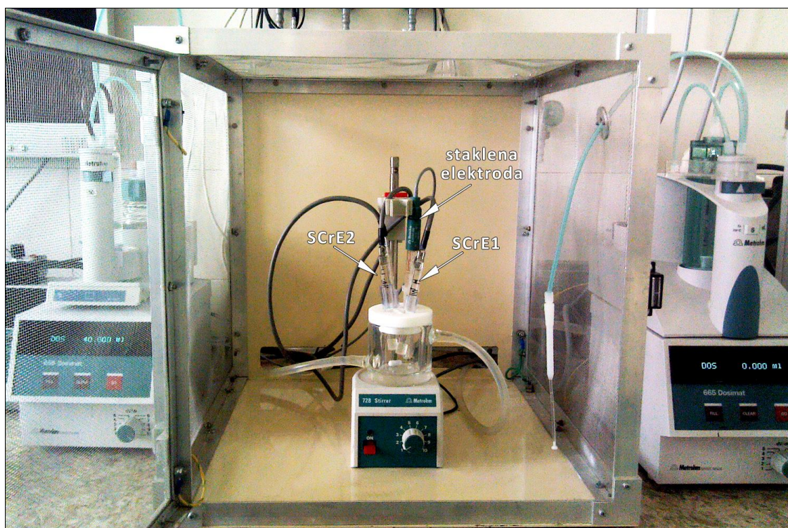
Slika 4.4. Eksperimentalni postav za potenciometrijska mjerenja u uzemljenom Faradayevom kavezu.
