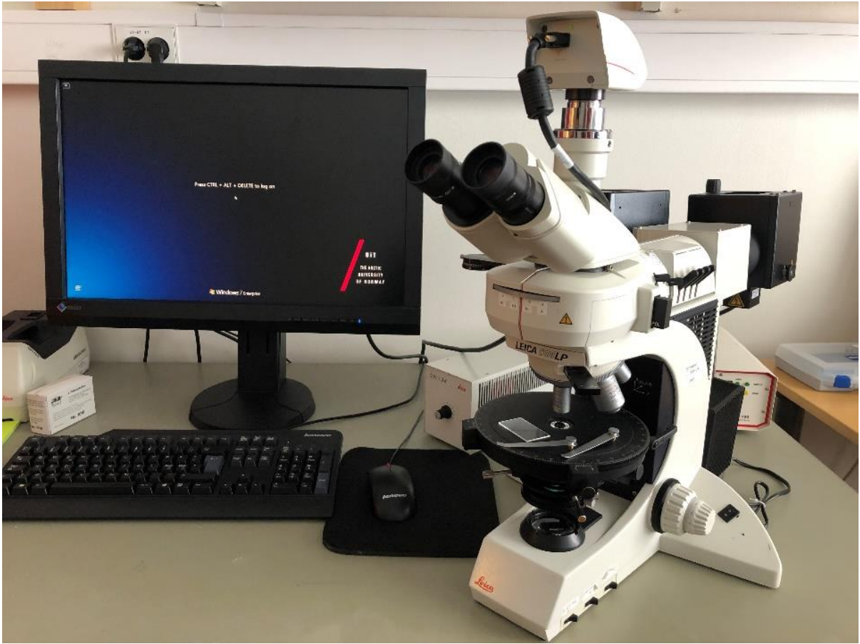
Slika 11. Mikroskop korišten za rudnu mikroskopiju.
