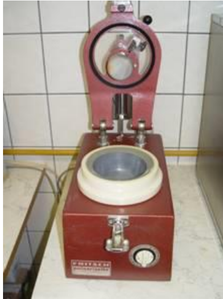
Slika 2. Ahatni mlin Fritsch pulverisette.
