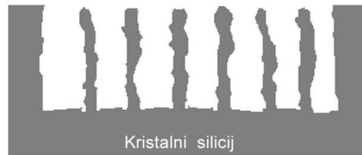
Slika 10. Shematski prikaz poroznog silicija na podlozi od kristalnog silicija [13].
