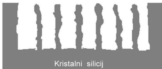
Slika 10. Shematski prikaz porognog silicija na podlozi od kristalnog silicija [13].
