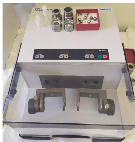
Slika 15. Vibracijski mlin, posudice i kuglice za mljevenje.
