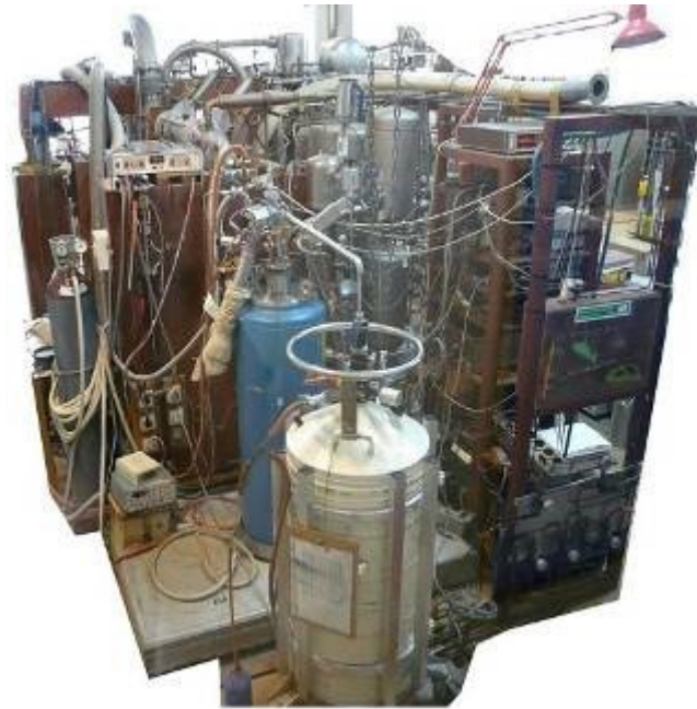
Slika 3.8: Dilucijski kriostat kućne izvedbe.
