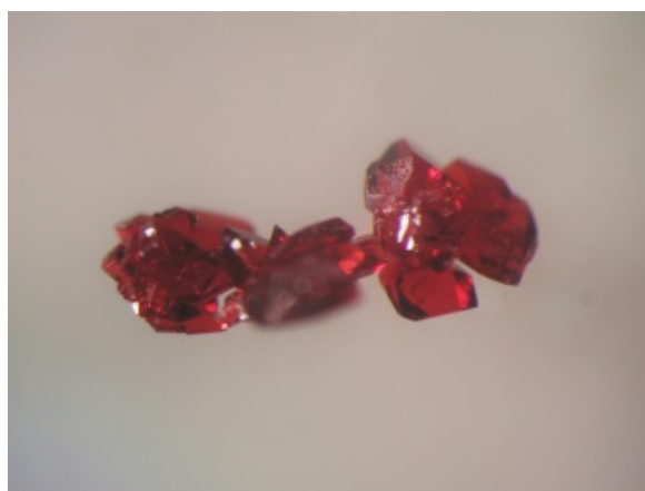
Slika 18: Fotografija jediničnih kristala kompleksa 3\text{Na}[\text{CoC}_2\text{O}_4(\text{NH}_3)_4][\text{Mo}_2\text{O}_4(\mu\text{-O})_2(\text{C}_2\text{O}_4)_2]
