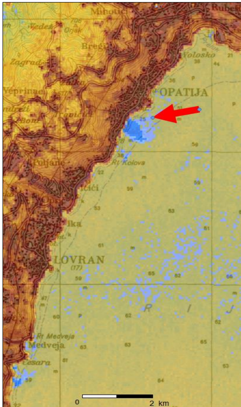
Sl. 22. Prikaz termalne infracrvene snimke istjecanja podzemnih voda na prostoru Opatijskoga primorja 12.06.2002. – strjelicom je označena središnja zona istjecanja (Slatina – Kristal – Admiral)
