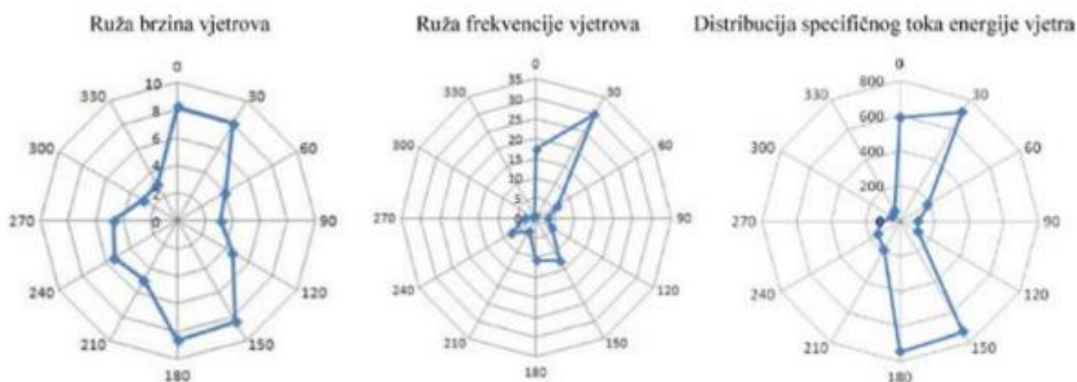
Sl. 10 Ruže vjetrova za brzinu, frekvenciju i distribuciju specifičnog toka energije vjetra izmjerena na visini 50 metara za potrebe VE Mesihovina na Grabovičkoj zaravni u razdoblju 2004. – 2013. (Marinčić, 2014)
