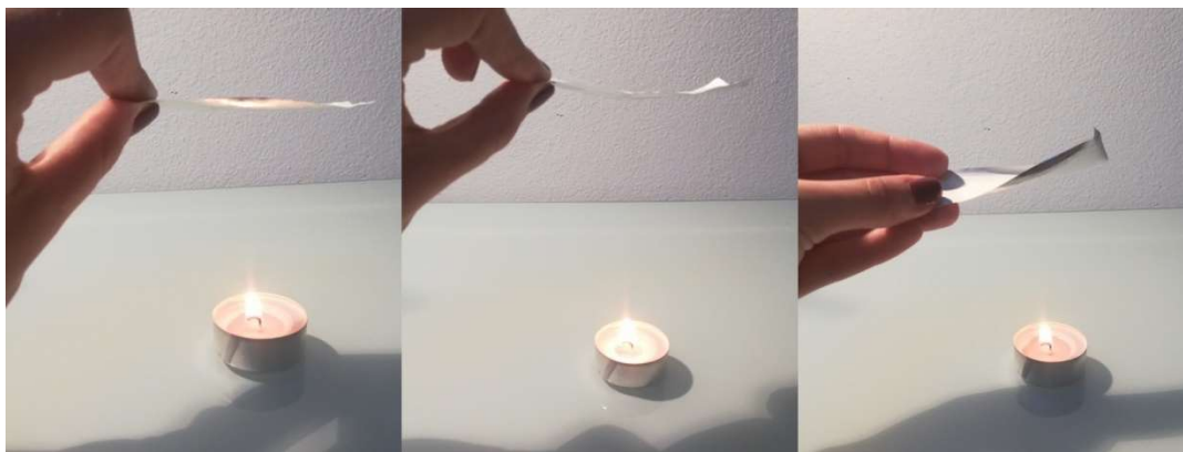
Slika 5.3.2. – Prikaz toplinskog rastezanja različitih materijala
