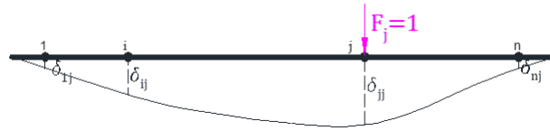
Slika 1.1: Pomak štapa pod djelovanjem jedinične sile u čvoru k
