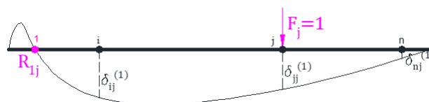
Slika 1.3: Pomak štapa pod djelovanjem jedinične sile u čvoru j, nakon uravnoteženja u čvoru 1
