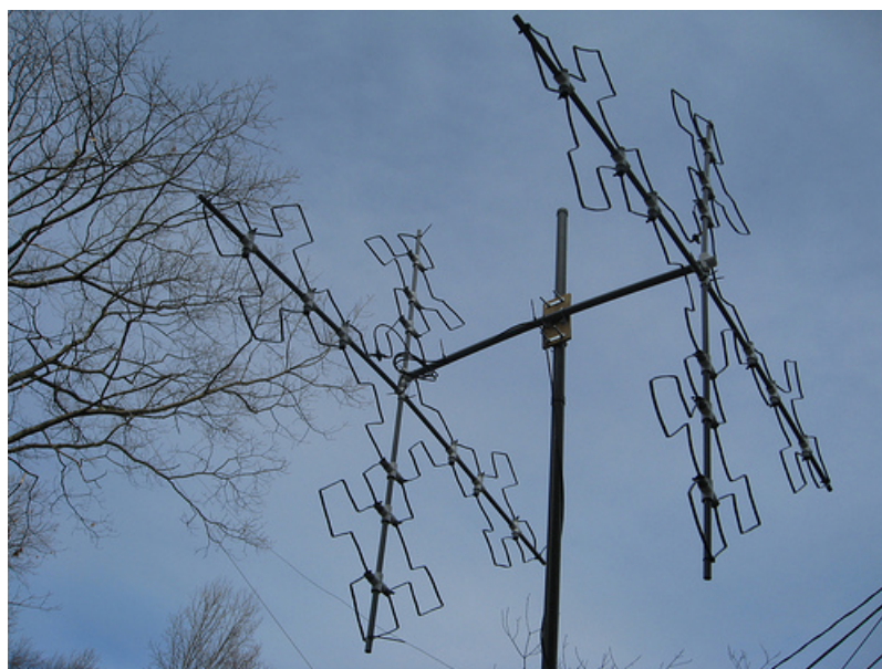
Slika 3.6: Model kućne fraktalne antene
