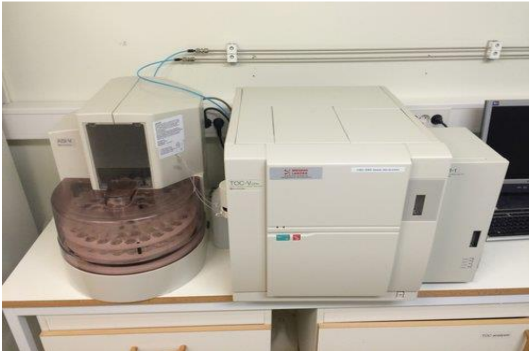
Slika 14. Uređaj Shimadzu TOC-V CPH (preuzeto iz URL 7).
