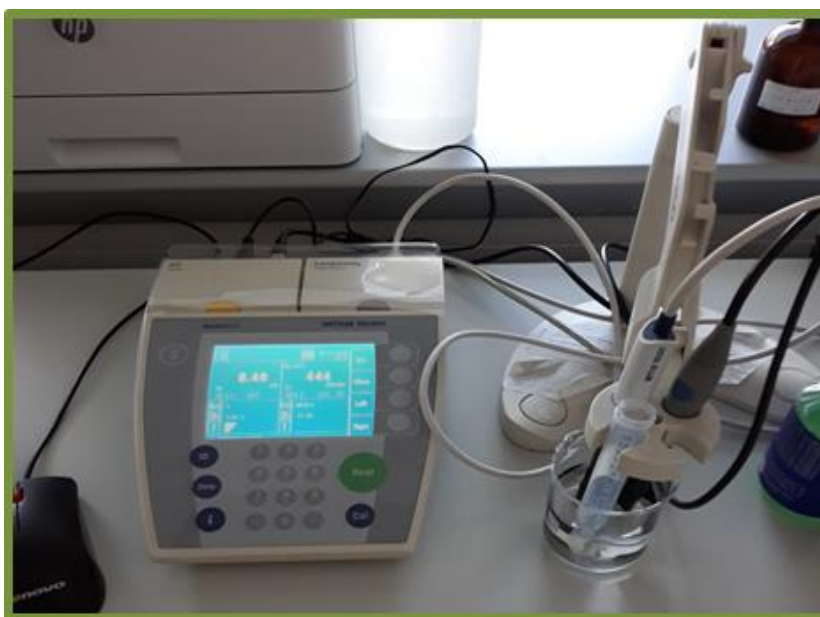
Slika 10. Uređaj za mjerenje pH i električne vodljivosti (Hrvatske vode).
