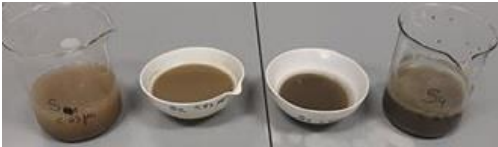
Slika 12. Uzorci prikupljenog sedimenta nakon prevedenog mokrog sisanja
