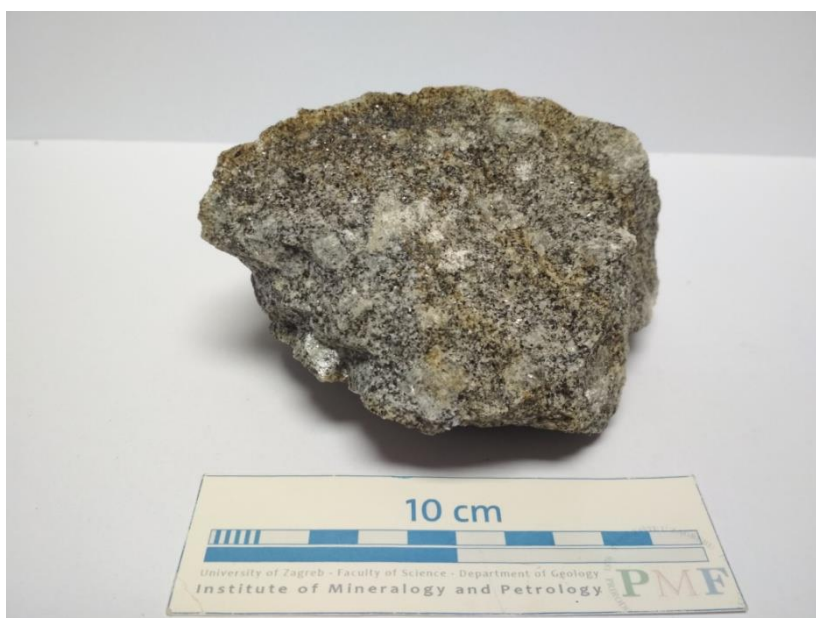
Slika 10. Makroskopski uzorak stijene 118. U tamnije zrnatoj osnovi ističu se leukokratski megakristali.
