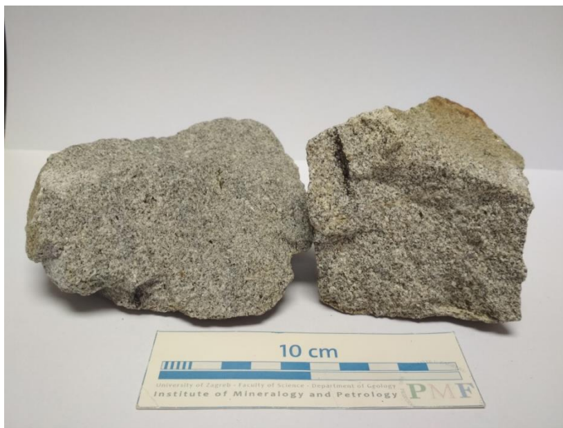
Slika 12. Makroskopski uzorci stijene 120 s mjerilom. U sitnozrnatoj osnovi nalazimo izduženi mafični agregat zrna biotita veličine par cm.
