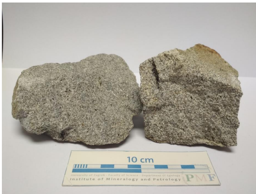
Slika 12. Makroskopski uzorci stijene 120 s mjerilom. U sitnozrnatoj osnovi nalazimo izduženi mafični agregat zrna biotita veličine par cm.
