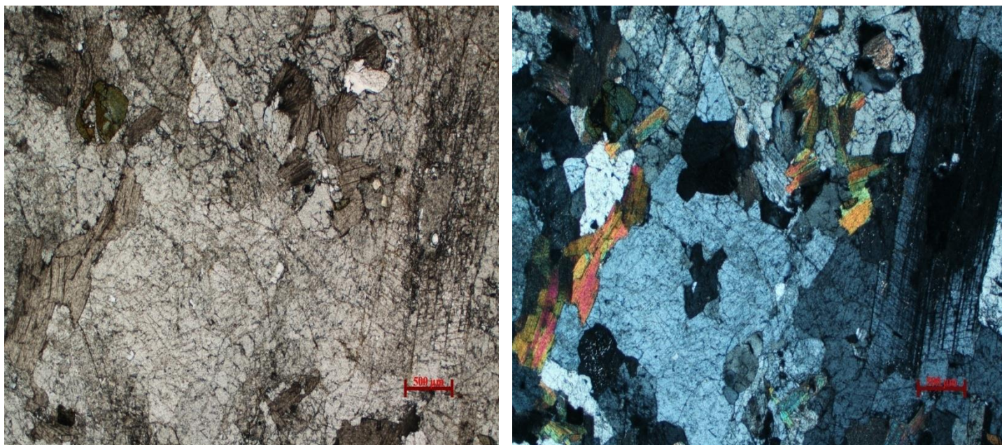
Slika 9. Mikroskopski uzorak 119a (N-, N+) sa unduloznim potamnjenjem kvarca i krupnijim zrnima.
