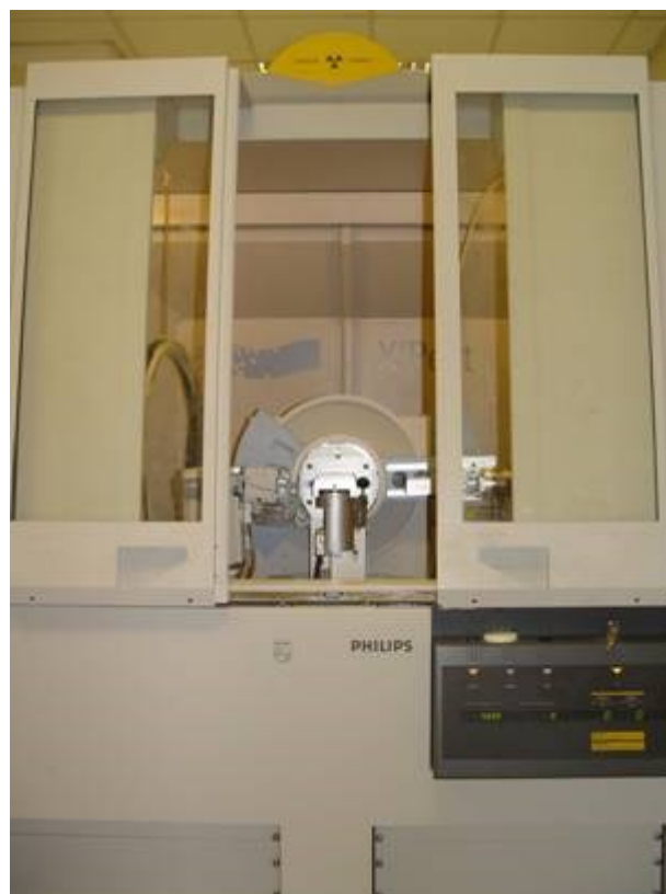
Slika 16. Philips PW3040/60 X'Pert PRO difraktometar
