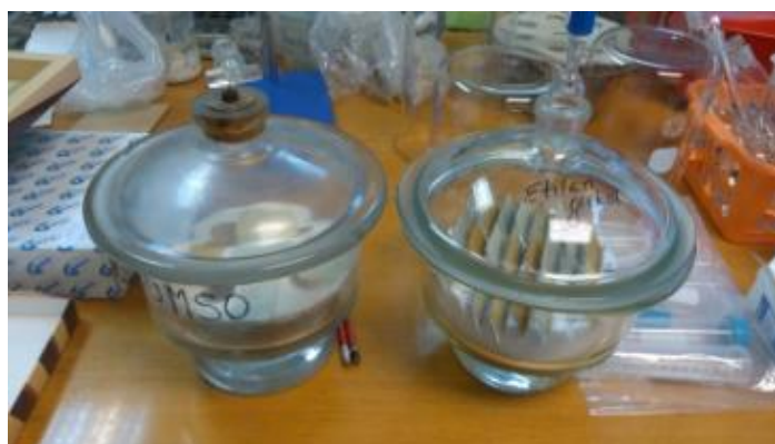
Slika 13. Tretiranje uzoraka etilen glikolom (EG) i dimetilsulfoksidom (DMSO)
