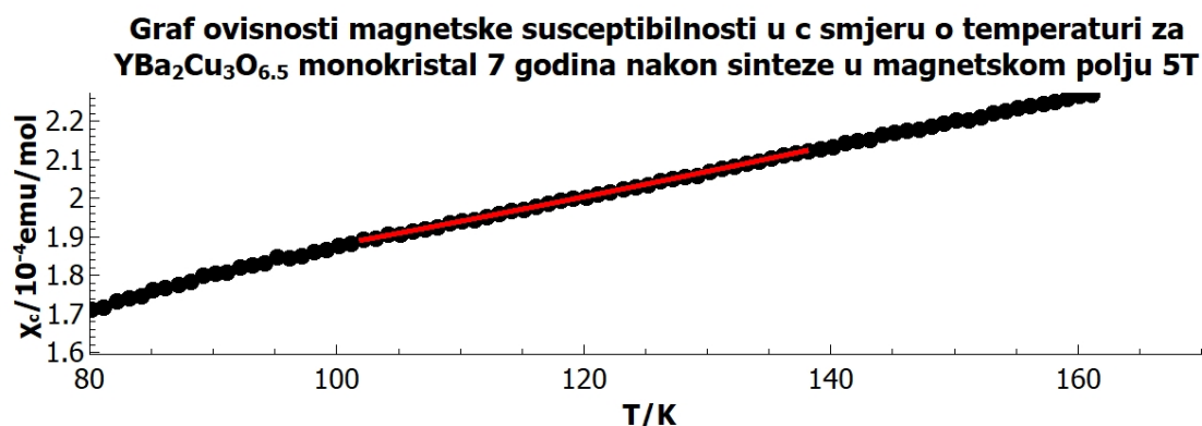
Slika 8.57: Na slici je prikazan graf ovisnosti magnetske susceptibilnosti po molu YBa 2 Cu 3 O 6.5 monokristala u c smjeru o temperaturi, u Curievom području. Gdje je za svako mjerenje magnetsko polje usmjereno u c smjeru, i iznosi H = 50000\text{Oe} (što odgovara magnetskom polju u vakuumu B = 5\text{T} ). Mjerenje je rađeno za YBCO uzorak nakon sinteze. Na graf je "fitana" funkcija y = Ax + B + C/x s parametrima A = (7.8 \pm 0.4) \cdot 10^{-7}\text{emu/molK} B = (0.91 \pm 0.09) \cdot 10^{-4}\text{emu/mol} C = (19 \pm 5) \cdot 10^{-4}\text{emuK/mol} .
