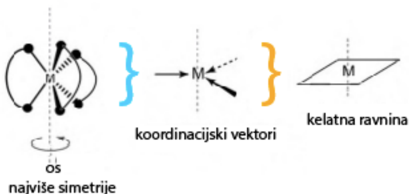
Slika 25. Koordinacijski vektori su vektori kolinearni metal-ligand vezama monodentatnih liganada, to su vektori okomiti na metal-ligand vezu kelatnih liganada te prolaze njenim središtem. Nakupina kolinearnih koordinacijskih vektora tvori tzv. kelatnu ravninu metalnog čvora
