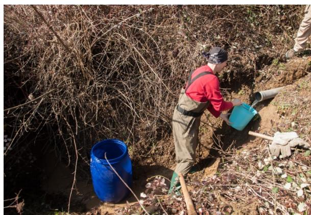
*Slika 25. Mjerenje protoka na ponoru (P)*
