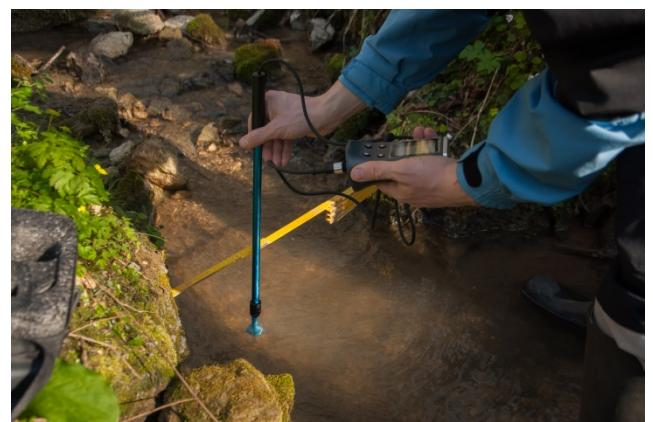
*Slika 26. Mjerenje brzine toka na izvoru (I2)*
