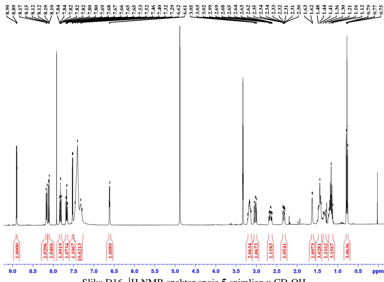
Slika D16.  $^1\text{H}$  NMR spektar spoja **5** snimljen u  $\text{CD}_3\text{OH}$
