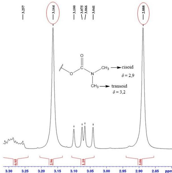
Slika 15. Uvećani prikaz signalova protona metilne skupine u  $^1\text{H}$  NMR spektru spoja 3
