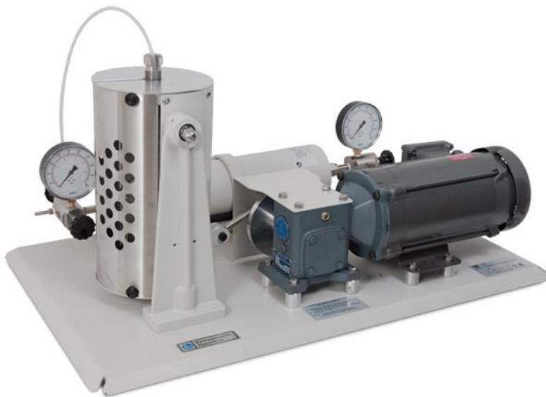
Slika 6. Parrova aparatura za hidrogeniranje<sup>14</sup>
