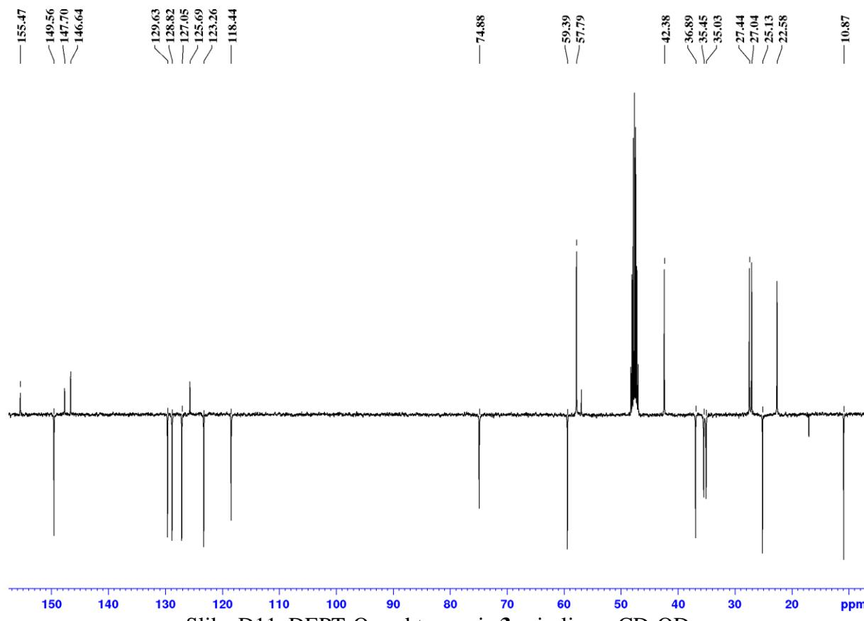
Slika D11. DEPT-Q spektar spoja 3 snimljen u  $\text{CD}_3\text{OD}$
