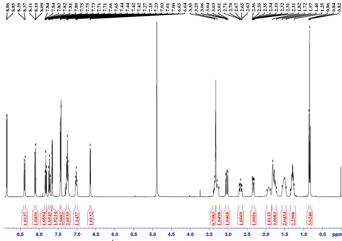
Slika D5.  $^1\text{H}$  NMR spektar spoja **2** snimljen u  $\text{CD}_3\text{OD}$
