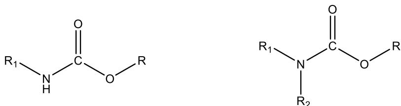
Slika 8. Srtuktura formula mono- i disupstituiranog karbamata
