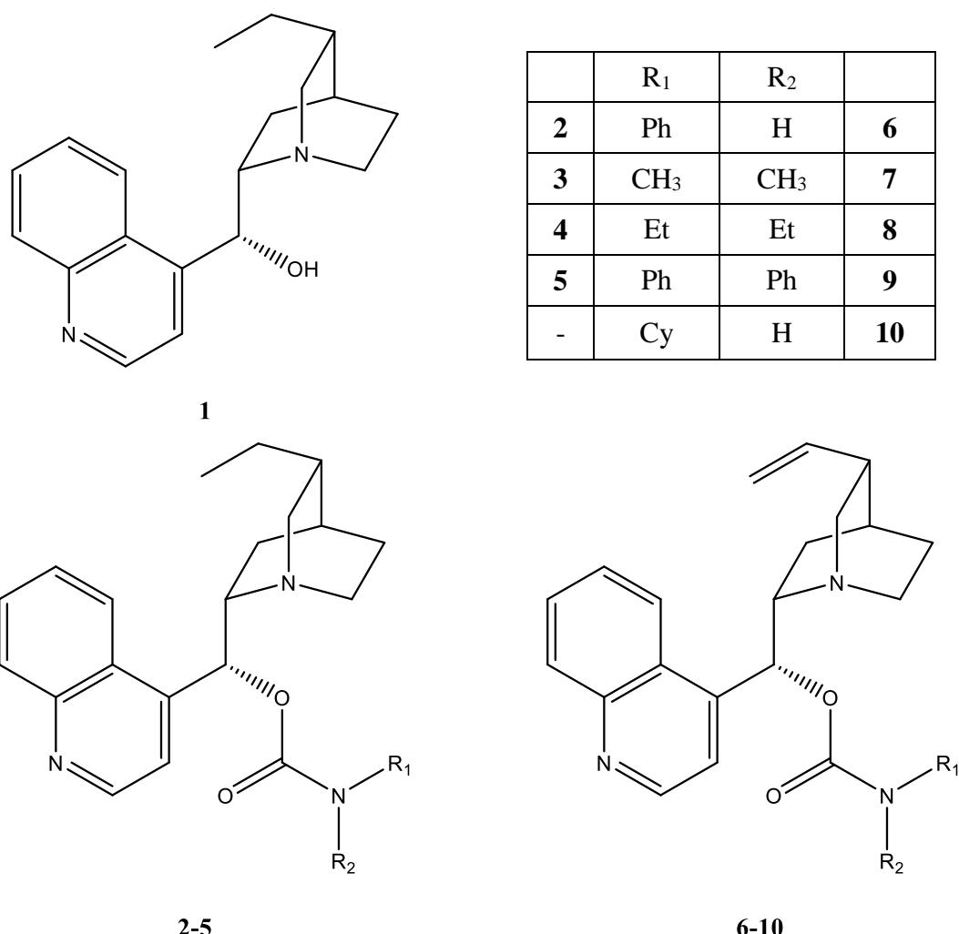
Slika 13. Strukture sintetiziranih spojeva 10,11-dihidrocinchonidina (**1**) te serije karbamatnih derivata 10,11-dihidrocinchonidina (**2-5**) i cinhonidina (**6-10**).
