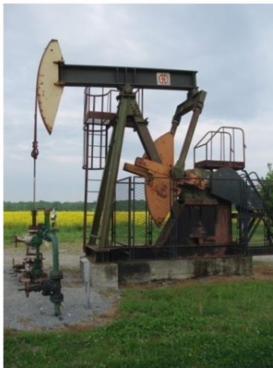
Slika 6.: Naftna bušotina s dubinskom sisaljkom
