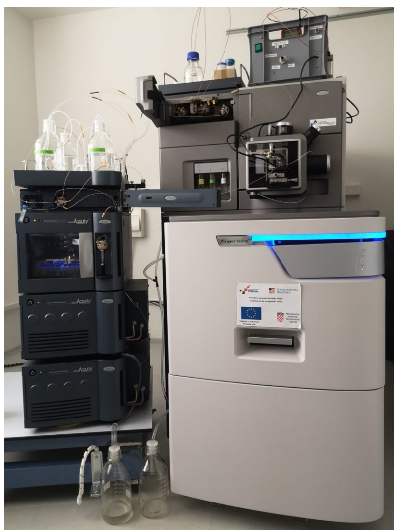
Slika 7. Vezani sustav nano ACQUITY UPLC (Waters, Milford, MA, SAD) sa sustavom spektrometrije masa visoke rezolucije SYNAPT G2-Si (Waters, Milford, MA, SAD).
